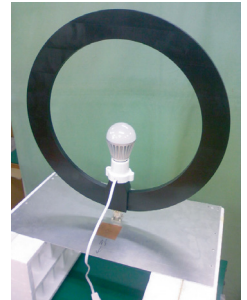
LED照明の放射雑音測定
