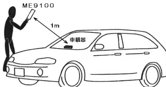
また、図に示すように ME9100 と車載器を平行に対向させ、1m(0.8～1.2m の範囲)離して試験を行います。
