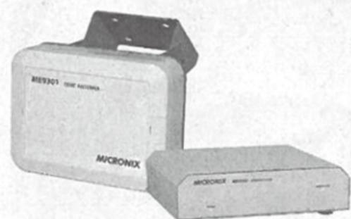
アンテナを設置して、同一車両が2地点を通過した時刻を記録し、時間差から混み具合を把握する。
