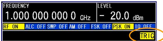
また、最初の有効なトリガ (立上りエッジ@TRIG IN、最初の TRIG キー押下@TRIG KEY) が入力されるまで、RF 信号はキャリアオフ状態となります。
