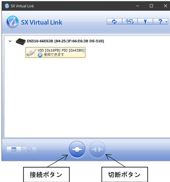
起動しなかった場合は、Windows メニューの[silex Tools]-[SX Virtual Link]より起動してください。本機器が認識されると、上記のようにデバイスが表示されます。デバイスを選択し、接続ボタンを押下してください。
