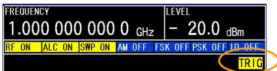
また、最初の有効なトリガ (立上りもしくは立下りエッジ@TRIG IN、最初の TRIG キー押し@TRIG KEY) が入力されるまで、RF 信号はスタート周波数/レベルで待機します。
