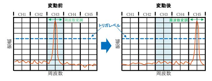
トリガ測定パラメータ: チャネルパワートリガ、CH3、スロープ:FALL、プリトリガ50%
