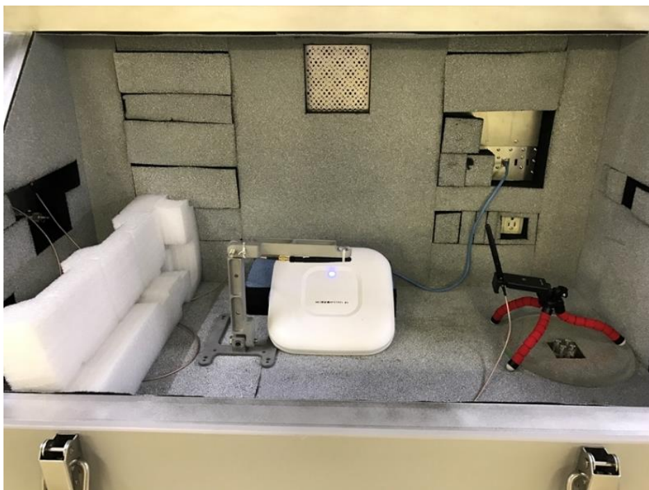
写真 1 ●試験時の電波暗箱内の様子
