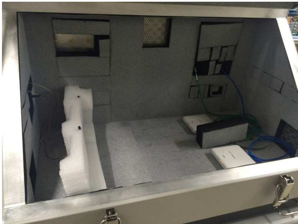
写真 2●2 台の 802.11n 対応アクセスポイントを同じチャネルで通信させてみて、速度を測定した
