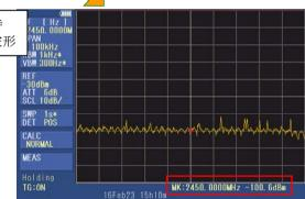
接続例では扉開時:-38.7dBm@2450MHzに対し、扉閉時:-100.6dBm@2450MHzとなっていますが、重要なのは基準値と定める"-100.6dBm"の実測値です。この基準値に対し、電界強度レベルが上がればシールド性能が劣化してきているとの判断になります。
